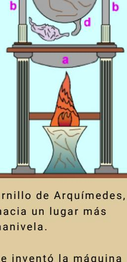
**Herón de Alejandría** inventó la Aelópila en el **siglo I d.C.**, primera turbina de vapor, es una máquina constituida por una cámara de aire, con tubos curvos por donde es expulsado el vapor. La fuerza resultante por esta expulsión hace que el mecanismo comience a girar, según la ley de acción-reacción.
